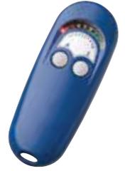
La LED iluminada permanecerá encendida sin necesidad de mantener pulsado ningún botón hasta que el medidor se apague. El medidor se apaga automáticamente 20 o 30 segundos después de la última vez que se haya pulsado cualquier botón.
