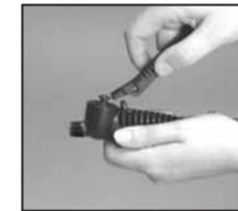
**9** Slide forks under plunger, push handle down until it snaps into place. Deslice las horquillas del mango por debajo del émbolo. Presione el mango hacia abajo hasta que se trabe en posición. Glisser la fourche sous le piston et appuyer sur la poignée jusqu'à ce qu'elle s'enclenche en place.
