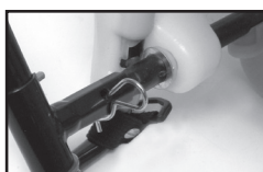
Figure 3 Glissez la goupille à travers les trous.
