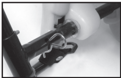
Figura 3 Deslice el pasador por los orificios.
