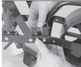
Une fois les trous alignés, insérez 4 boulons et fixez les 4 écrous.
