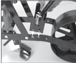
Alignez la plaque de base du marqueur de rangée à l'aide des 4 orifices correspondants sur l'assemblage de la trémie/roue, comme il est indiqué.
