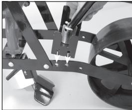
Alinee la placa base del marcador de surcos con los 4 hoyos correspondientes en el ensamblaje de la argolla/rueda, como se indica.
