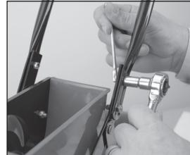
Utilice 4 tuercas y 4 pernos para asegurar la manija al ensamblado de la argolla/rueda, como se muestra
