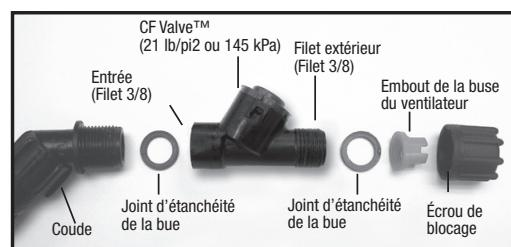
Le CF Valve™ doit être utilisé avec une buse fixe. L'embout de la buse en éventail est d'une valeur nominale @ 0,4 g/min (1 514 ml/min) @ 40 lb/po² (276 kPa).
