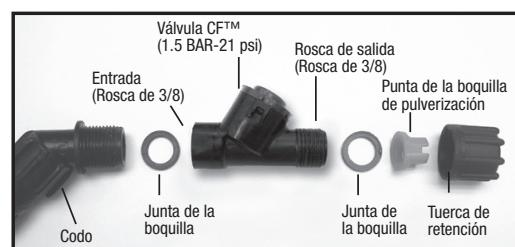
La Válvula CF™ está diseñada para usarse con una boquilla fija. La punta de la boquilla de pulverización que se proporciona está calculada para una capacidad de .4 galones por minuto a una presión de 40psi.
